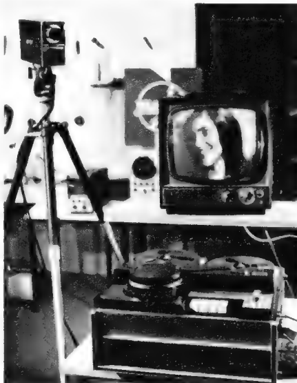
Videoaufzeichnungsgerät mit 30,3 cm/sec Bandgeschwindigkeit von National mit Kleinkamera und Empfänger als Monitor (Aufn.: Schwahn )
